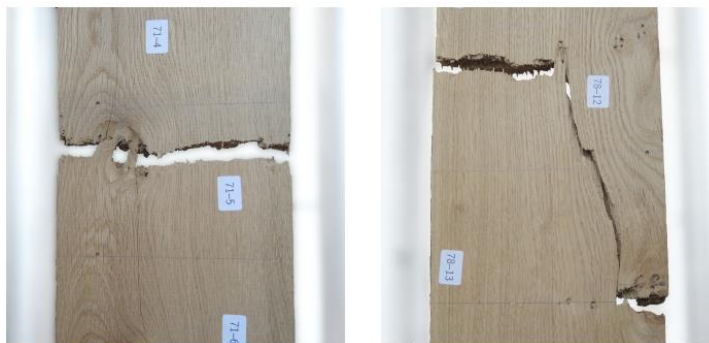
Slika 8. a) linija loma je okomita na uzdužnu os lamele; b) linija loma prati nagib vlakanaca
