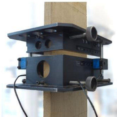
Slika 7. Ekstenzometar za mjerenje deformacija segmenata lamela [25]
